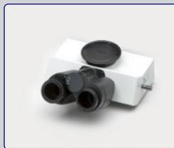
Tubo trinocular (FN22) com inclinação de 30° e ajuste da distância interpupilar. Seletor de partição de luz (binocular/câmera: 100/0, 20/80, 0/100).
