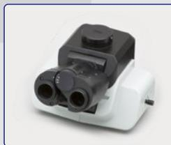
Tubo de observação trinocular inclinável (FN22) com inclinação ajustável de 5°-35° e ajuste da distância interpupilar. Seletor de partição de luz (binocular/câmera: 0/100, 100/0, 50/50).
