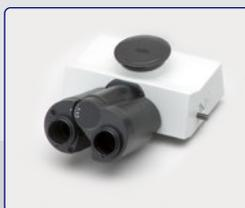
Tubo trinocular super amplo (FN 26,5), com inclinação fixa de 24° e ajuste da distância interpupilar. Seletor de partição de luz (binocular/câmera: 0/100, 100/0, 20/80).
