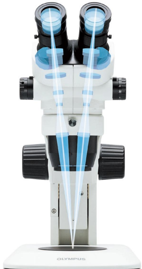
*Das Greenough-Optiksystem besitzt zwei Zoom-Strahlengänge, die in einem Winkel von 10° geneigt sind. Dies ermöglicht einen kompakten Mikroskopaufbau mit besten Eigenschaften.*
