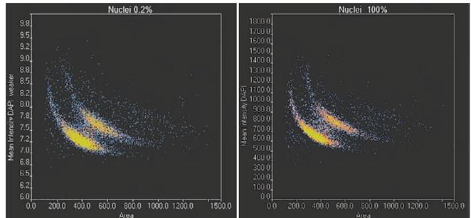
Convalida del test per ciclo cellulare a bassa esposizione luminosa (0,2%) con intelligenza artificiale (a sinistra) in confronto al test di riferimento (a destra)
